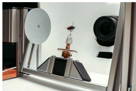
Abb. 2: Die Zoosphere Hardware mit Insekt auf einer U-Halterung und DSLR Kamera
