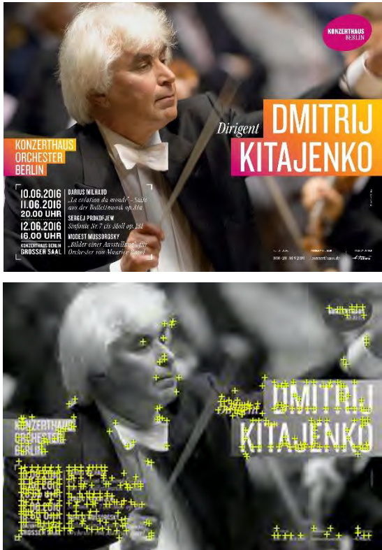
Abb. 4: Beispielplakat, welches als Marker genutzt wird (oben) & dazugehörige gefundene Feature Points (unten) [3]
