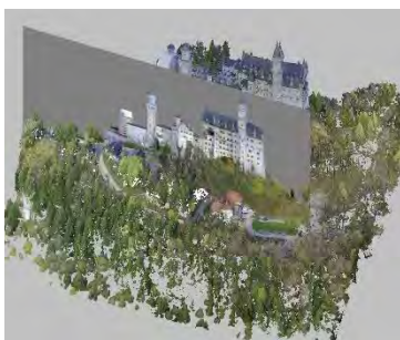
Abb. 5: Orthophotos aus Punktwolken am Beispiel Neuschwanstein.
